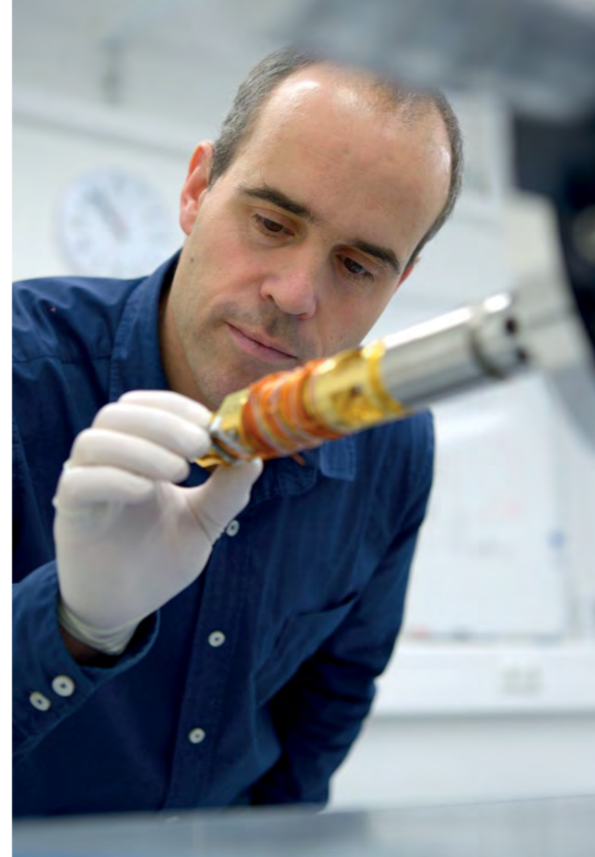
Jascha Repp hantiert am sogenannten Manipulator, der dazu dient, im Vakuum eine Probe zu greifen und zu positionieren. Rechts oben: Blick durch ein Fenster in die etwa zwei Quadratmeter große Vakuumstahlkammer, darin ist der Arm des Manipulators erkennbar. Am Elektronikarbeitsplatz im Regensburger Hightech-Labor (links, mittleres Bild) ist er gerade mit filigranen Justierungen an elektronischen Bauteilen beschäftigt, die den Antrieb für ein Rastertunnelmikroskop steuern. Unten im Bild: Bauteil eines Verdampfers.
