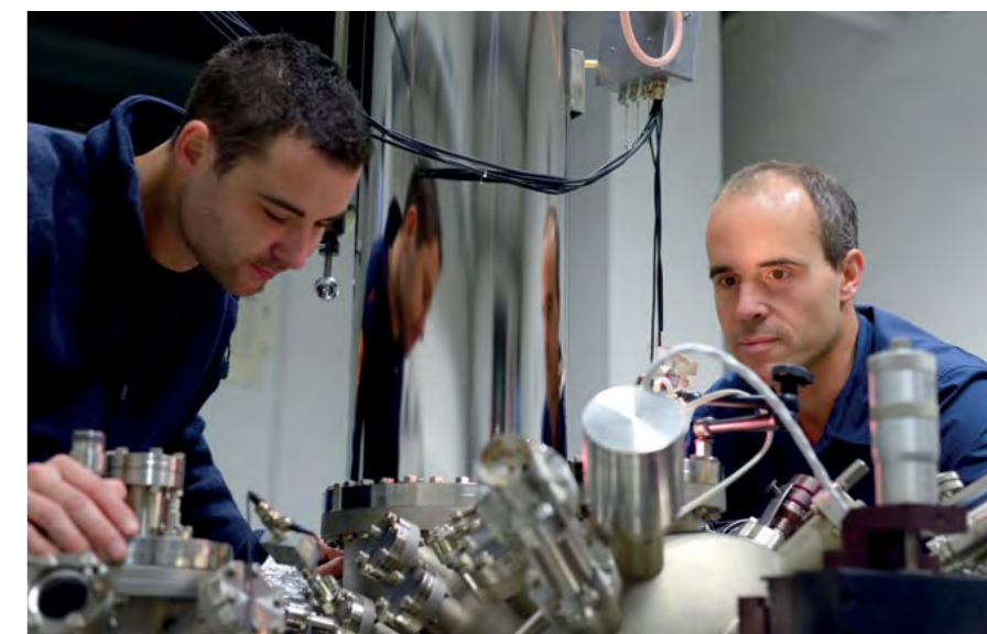
Eine kleine Stahlkammer ist entscheidend für die Forschung von Jascha Repp und seinem Team. Hier schaut der Lichtenberg-Professor in die Vakuumkammer, in der das Rastertunnelmikroskop installiert ist. Zugleich hantiert Techniker Andreas Pöhlmann an dem Kryostat, der zum Kühlen des Experiments benötigt wird.
