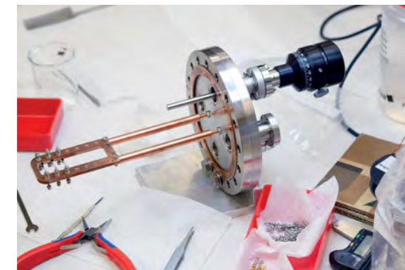
Jascha Repp hantiert am sogenannten Manipulator, der dazu dient, im Vakuum eine Probe zu greifen und zu positionieren. Rechts oben: Blick durch ein Fenster in die etwa zwei Quadratmeter große Vakuumstahlkammer, darin ist der Arm des Manipulators erkennbar. Am Elektronikarbeitsplatz im Regensburger Hightech-Labor (links, mittleres Bild) ist er gerade mit filigranen Justierungen an elektronischen Bauteilen beschäftigt, die den Antrieb für ein Rastertunnelmikroskop steuern. Unten im Bild: Bauteil eines Verdampfers.
