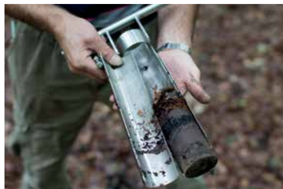
Die mit Stechzylindern gewonnenen Bodenproben werden im Labor hinsichtlich der Nährstoffe analysiert. The soil samples are taken to the laboratory for nutrient analysis.
